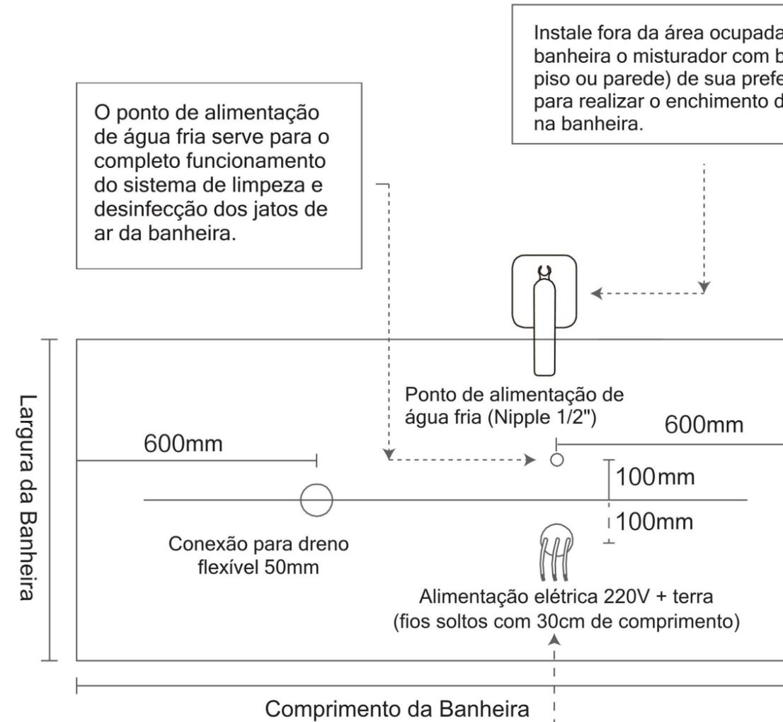
O ponto de alimentação de água fria serve para o completo funcionamento do sistema de limpeza e desinfecção dos jatos de ar da banheira.
